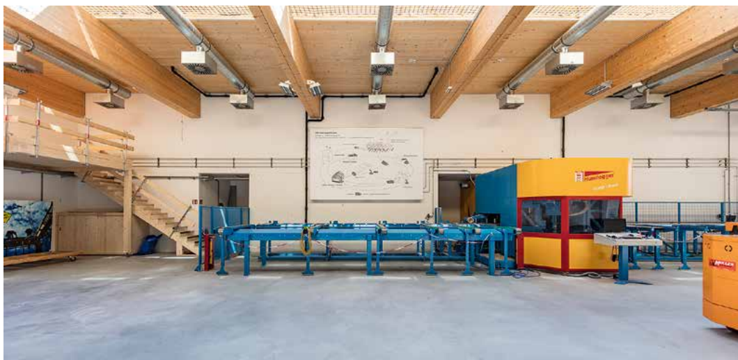
» Halle des Tirolignums mit einer CNC Abbundanlage der Marke Robot Drive der Fa. Hundegger
