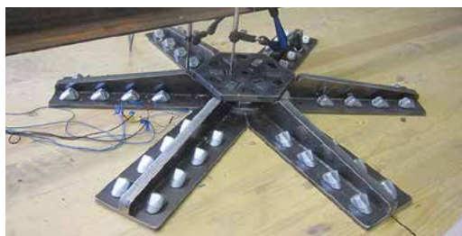
► SPIDER Connector Verstärkungselement im Laborversuch
